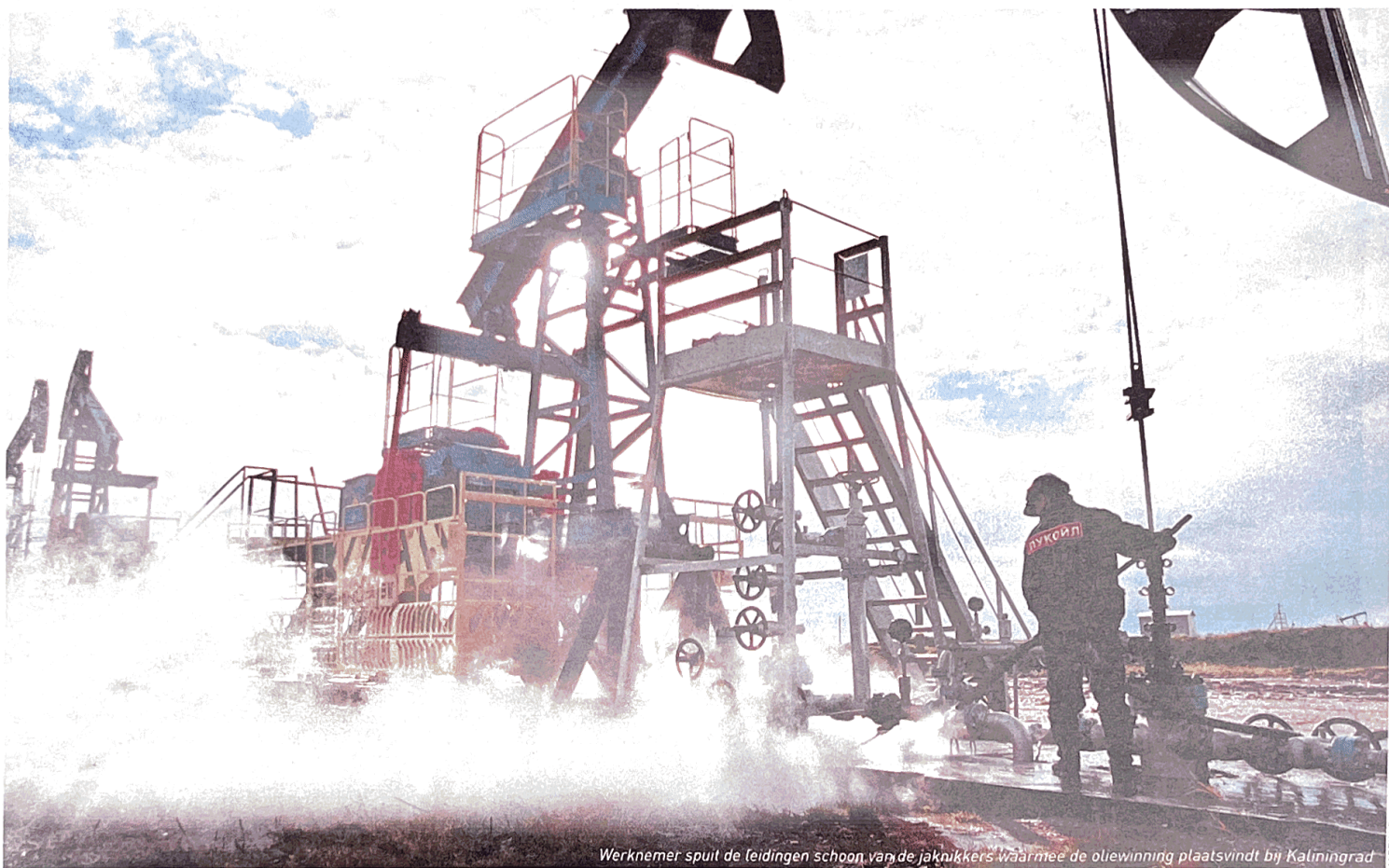
Werknemer spuit de leidingen schoon van de jaknikkers waarmee de oliewinning plaatsvindt bij Kaliningrad
